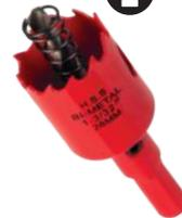
Unsere 28mm Lochsäge aus Bimetall überzeugt mit einer enormen Standfestigkeit dank der Kombination von HSS-Stahl und Cobalt-legiertem M42-Stahl. Die progressive Wechselverzahnung garantiert präzise, saubere Bohrungen in Aluminium, Holz, HPL, Kunststoff und Leichtmetall.
